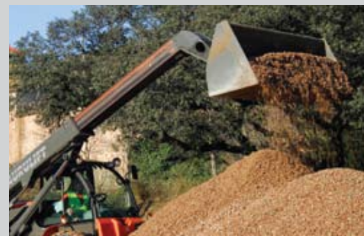
AUSA hidraulic bucket (700 l.)
